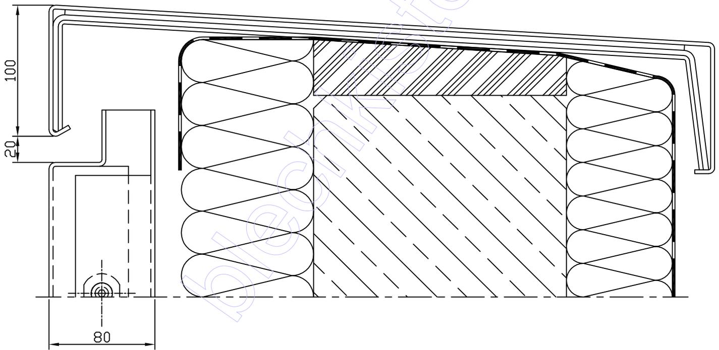
Bolzeneinhangfassade mit verdeckten Bolzen
