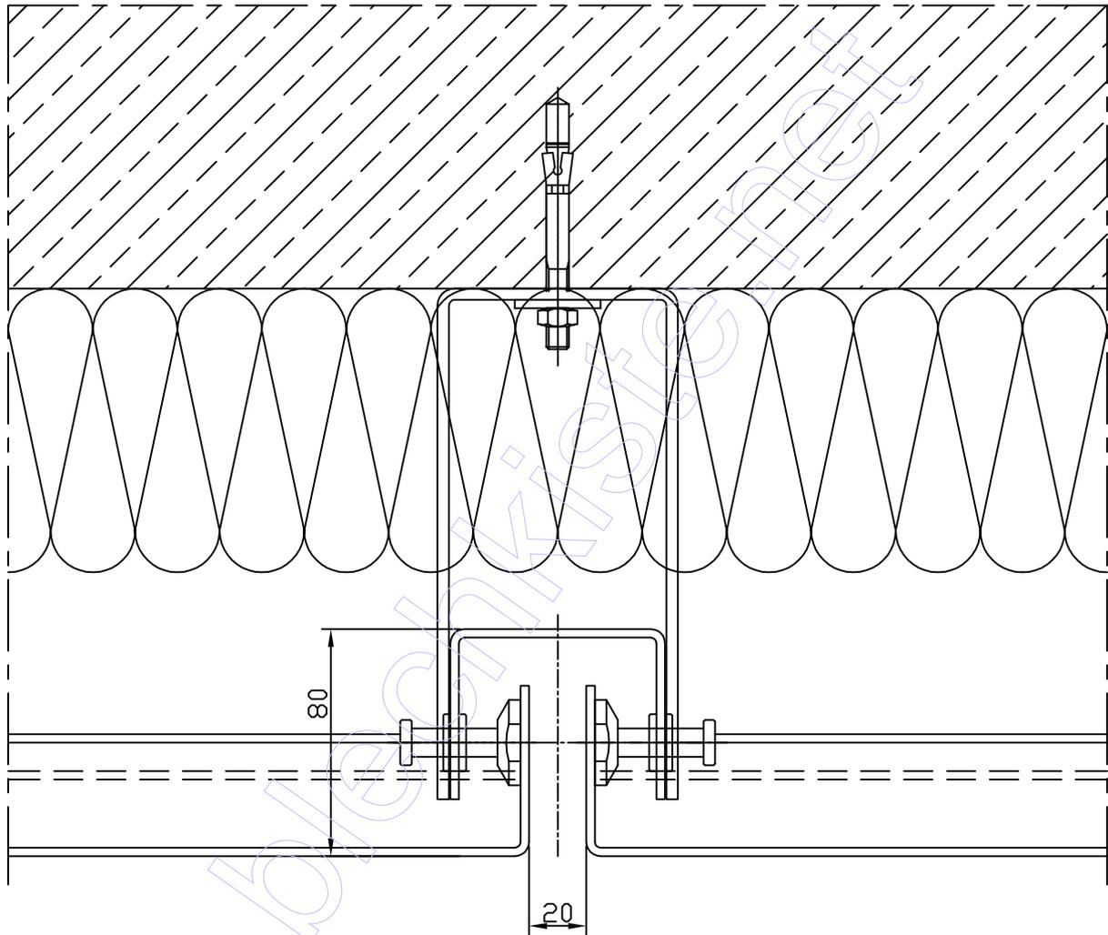
Bolzeneinhangfassade mit verdeckten Bolzen
